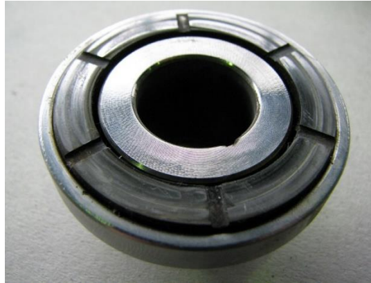
Рисунок 6.24 - Износ осевого промежуточного подшипника
