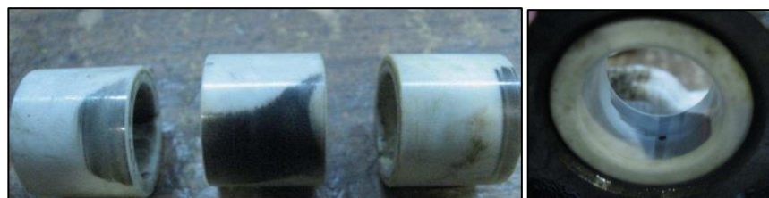
Рисунок 1.13 - Форма контакта втулок промежуточных подшипников из ZrO_2
