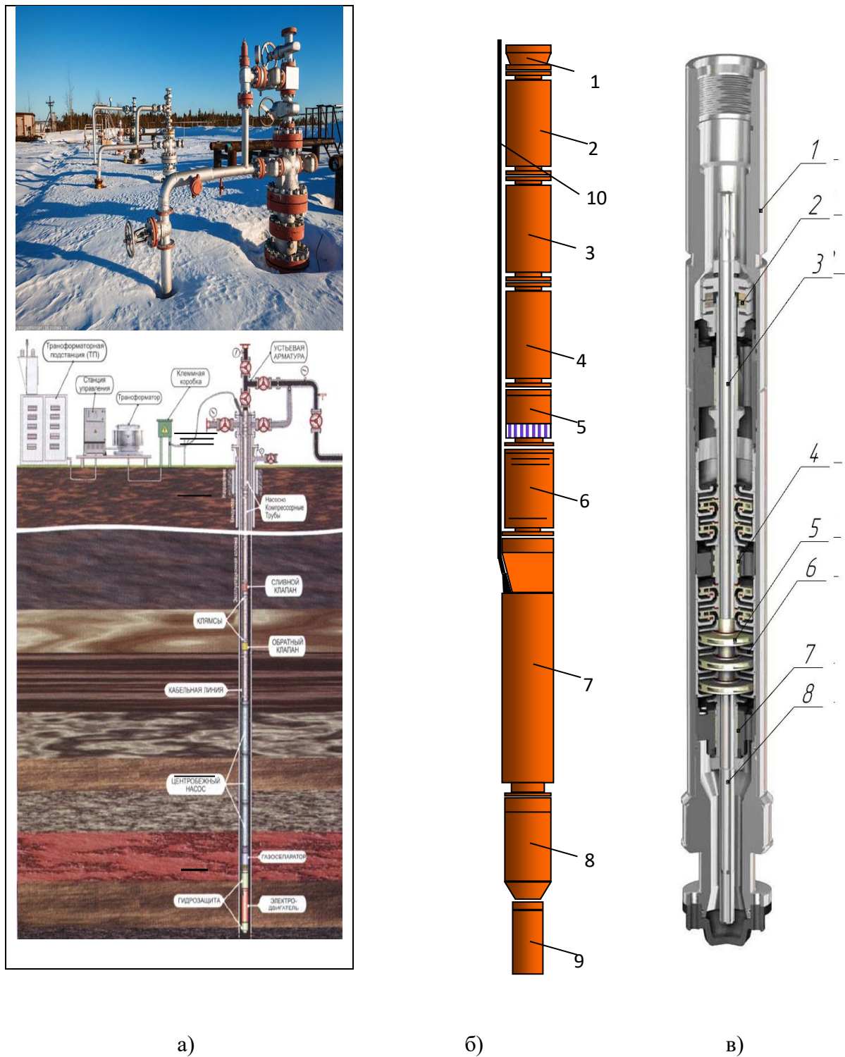
Рисунок 1.1 – Состав УЭЛН(УЭЦН): а) – УЭЦН ( http://Neftegaz.ru ); б) погружной насосный агрегата (1 – ловильная головка; 2 – насос, секция верхняя; 3 – насос, секция средняя; 4 – насос, секция нижняя; 5 – газосепаратор; 6 – гидрозащита; 7 – двигатель; 8 – компенсатор; 9 – датчик; 10 – кабель); в) насосная секция (1 - корпус, 2 -осевой подшипник, 3,7 - концевые
