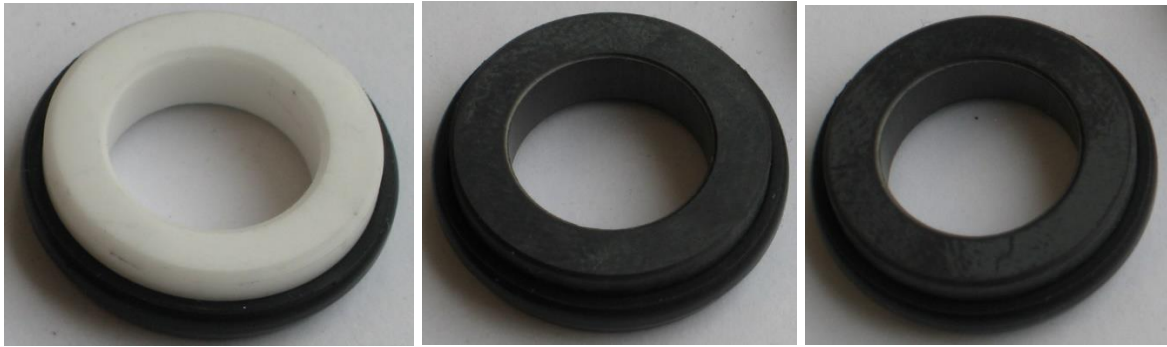
Рисунок 7.2.5 – общий вид торцовых уплотнений высокооборотных УЭЛН из различных материалов: Al_2O_3 ; WC; SiC
