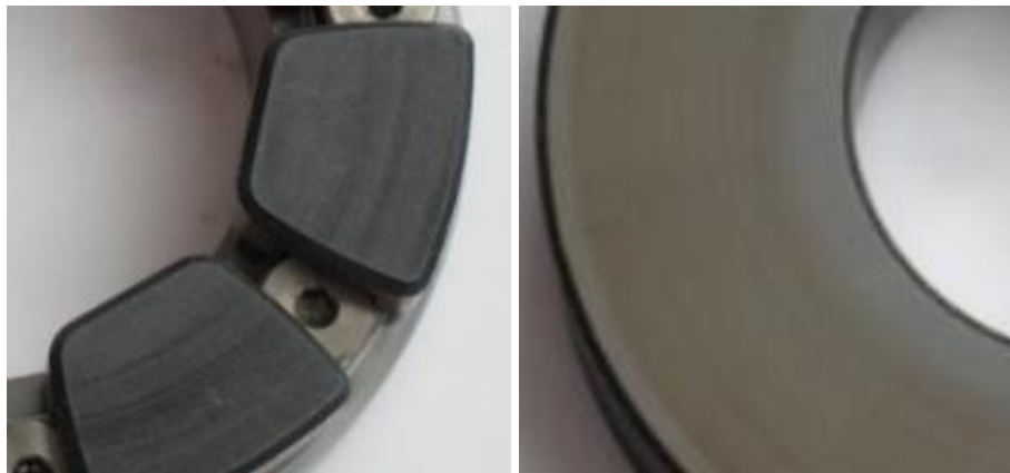
Рисунок 4.47 – Поверхность трения образца 14.1 после опыта
