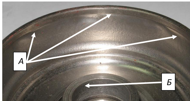
Рисунок 5.3 – Зоны разрушения НА в среде с проппантом
