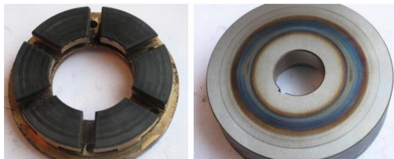
Рисунок 4.48 – Общий вид подшипника 7р после испытаний
