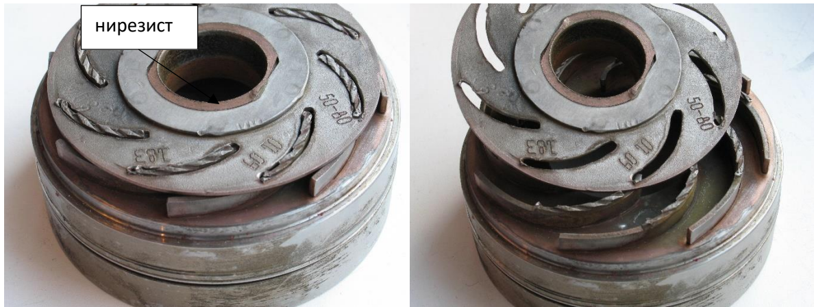
Рисунок 5.5 – Общий вид рабочих органов из стали 08X17Т после испытаний в коррозионно-активной среде
