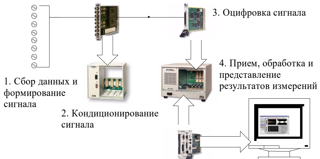
Рисунок 3.2 - Состав системы измерений вибрационных параметров насосной секции
