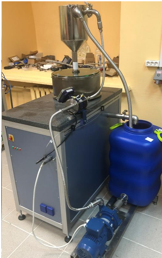
Рисунок 7.2.9 - Общий вид высокооборотного стенда для испытаний материалов СН, ГС на эрозионный износ
